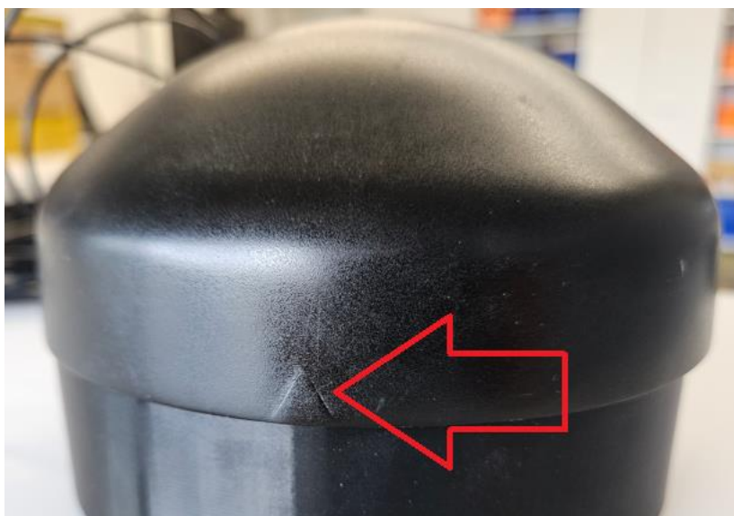
Рисунок 5.1 Метка на корпусе комбинированной антенны.
