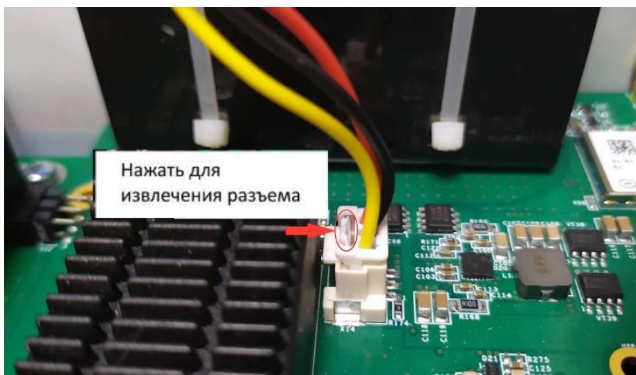
Рисунок 3.5.1 – Отключение АКБ
