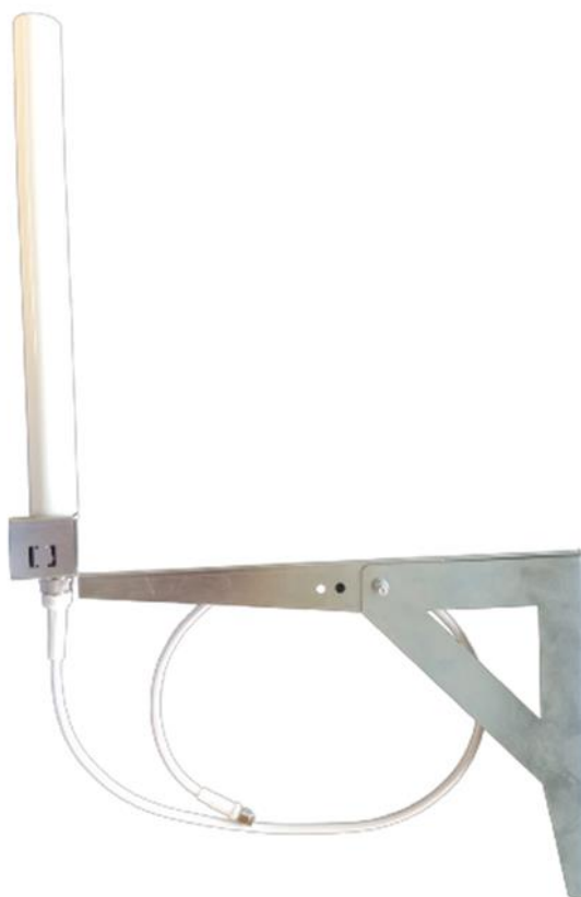
Рисунок 3.1.6 – Антенна Molex 2143900001, закрепленная на кронштейне ИЛПГ.741400.236, кабель SMA male-N female
