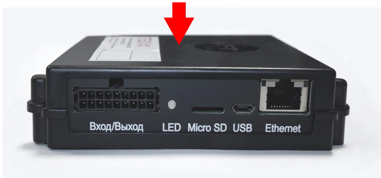
Рисунок 5.1. Ориентация устройства при установке в транспортном средстве
