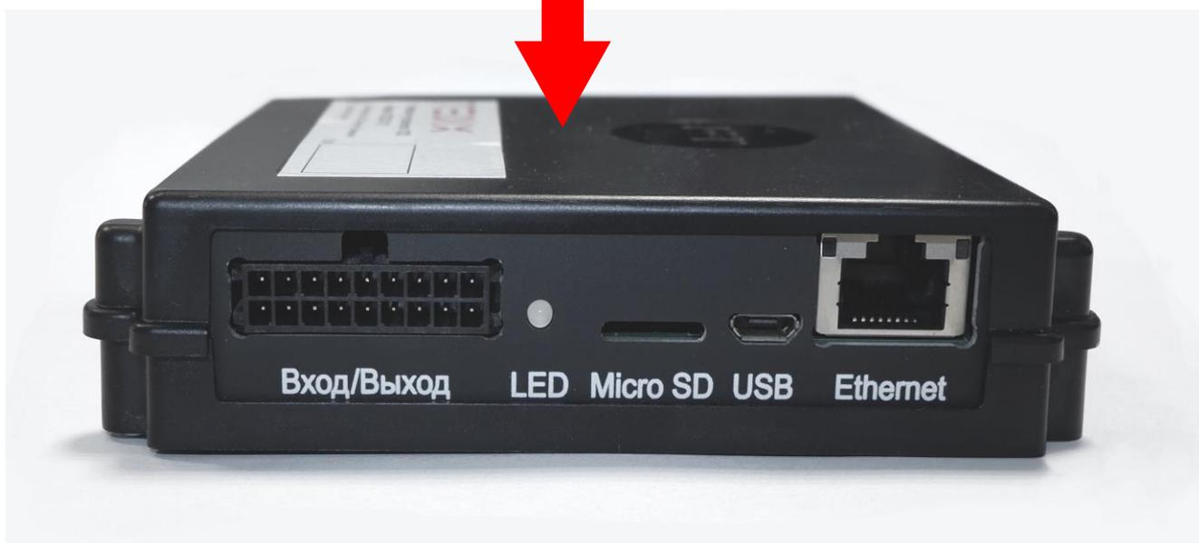
Рисунок 5.1. Ориентация устройства при установке в транспортном средстве
