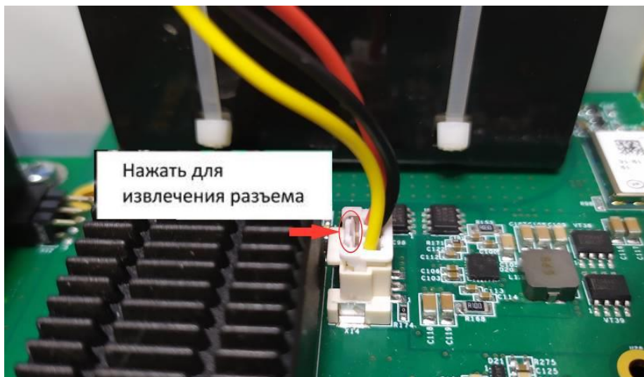
Рисунок 3.5.1 – Отключение АКБ
